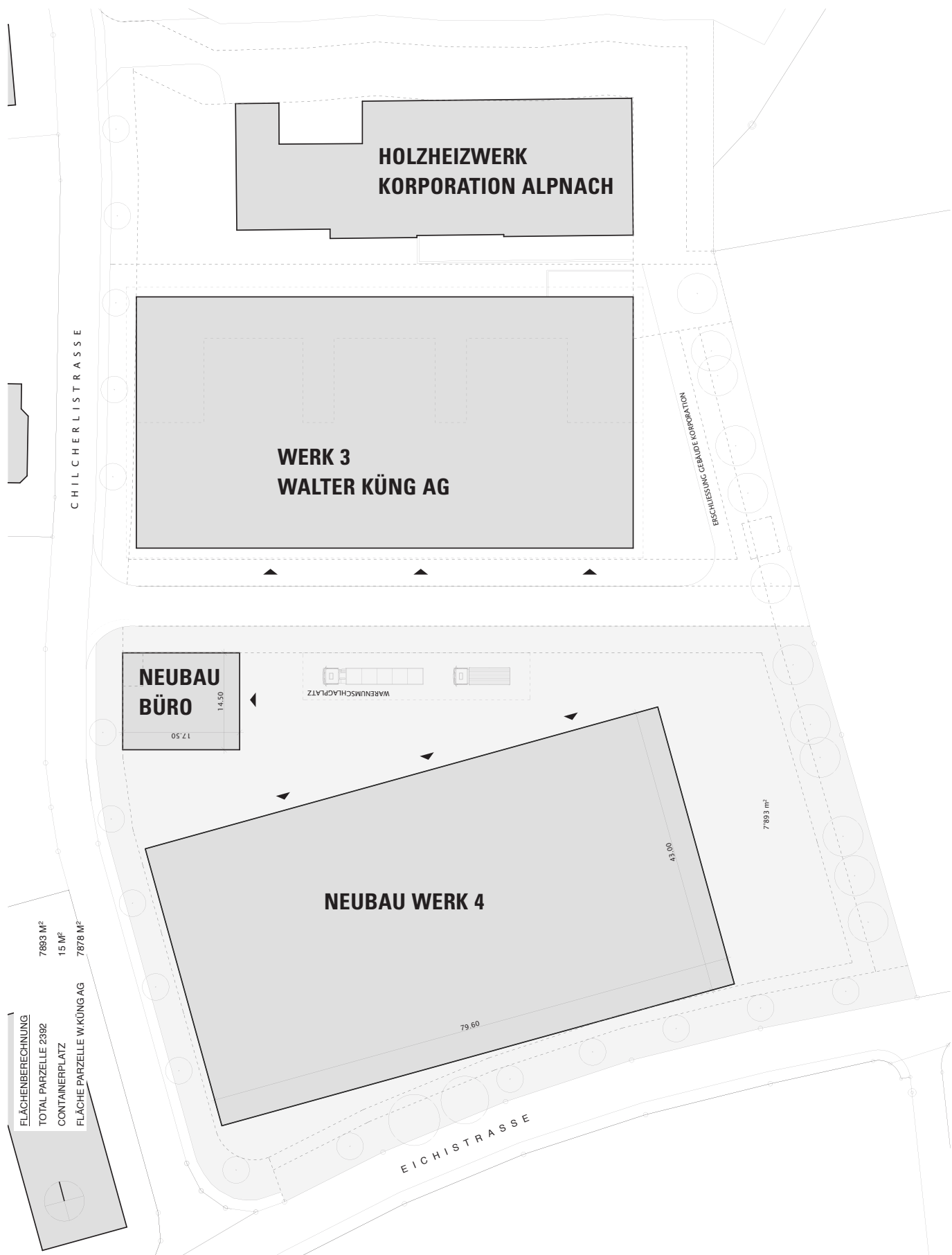
Situationsplan mit Grundriss der neuen Produktionshalle der Walter Kung AG
