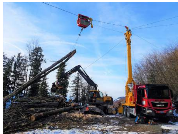
Neuer Mobilseilkran zusammen mit einem Pneubagger im Einsatz auf einem Holzlagerplatz
